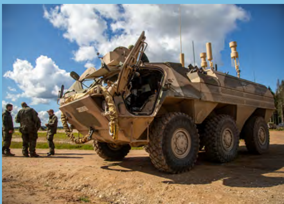
Un CG20+, système mobile allemand de lutte contre les drones, utilisé pendant l'exercice Baltic Trust 25 – Lettonie, août 2025.
