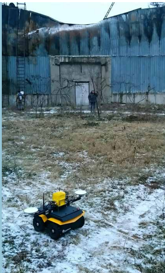
Mise à l'essai d'un des robots démineurs – Kharkiv (Ukraine), janvier 2023.
