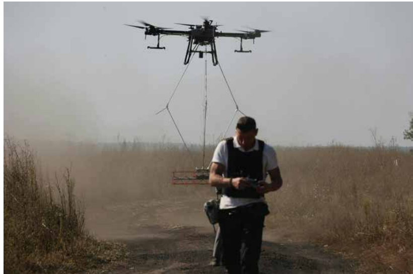
Un chercheur ukrainien teste un système permettant de détecter des mines terrestres au moyen de drones, dans le cadre d'un projet financé par le programme OTAN pour la science au service de la paix et de la sécurité – Kharkiv (Ukraine), juin 2023. Crédit photo : Viatcheslav Madiïevsky
