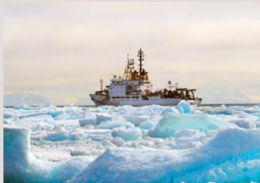
Le navire de recherche de l'OTAN, l'Alliance, stationné dans l'Arctique pendant les essais relatifs à la situation générale de l'environnement nordique. Navire le plus silencieux de sa classe, l'Alliance a été conçu pour que les ondes sonores qu'il émet dans l'eau soient les plus faibles possibles, ce qui en fait une excellente plateforme pour la mise à l'essai de sonars et de dispositifs acoustiques, et pour d'autres types de recherches nécessitant un environnement sous-marin calme – Océan Arctique, juin 2021.
