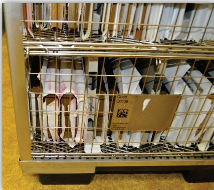
Obr. 2 Umístění knih do speciálních košů před vložením do technologie odkyselování Papersave Swiss. Autor fotografie Jitka Neoralová
