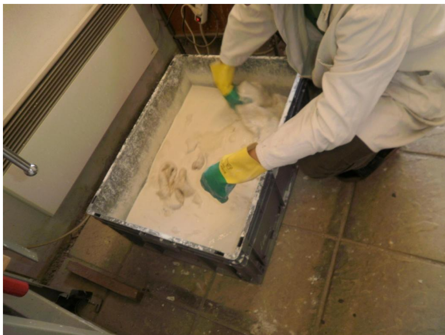
Obr. č. 2 Máčanie kože v roztoku haseného vápna
