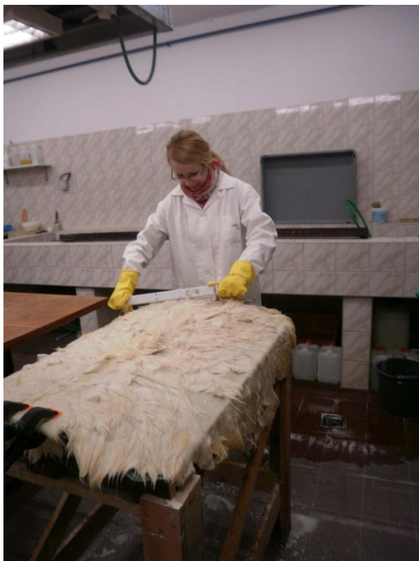
Obr. č. 3 Odchlpenie kože na kožiarskom stole
