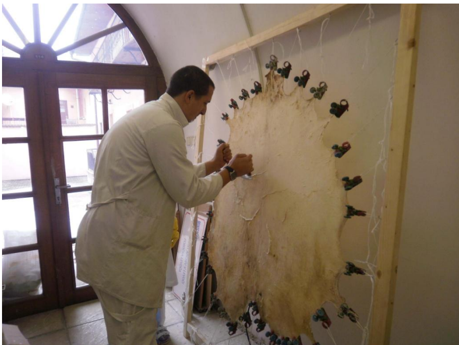
Obr. č. 5 Odstraňovanie zvyškov chlпов, podkožného tkaniva a zvyškov mäsa
